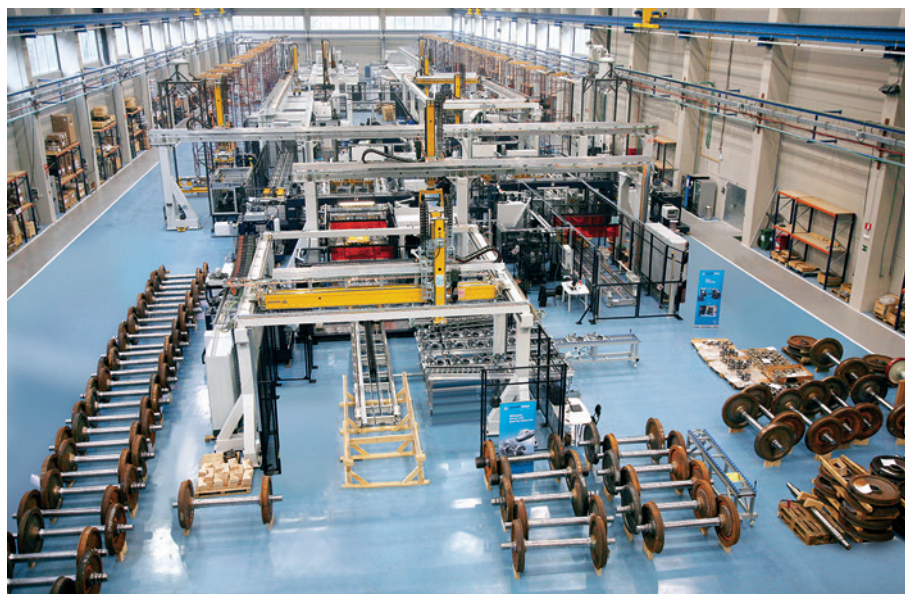
Línea de fabricación llave en mano para ejes montados de ferrocarril.
